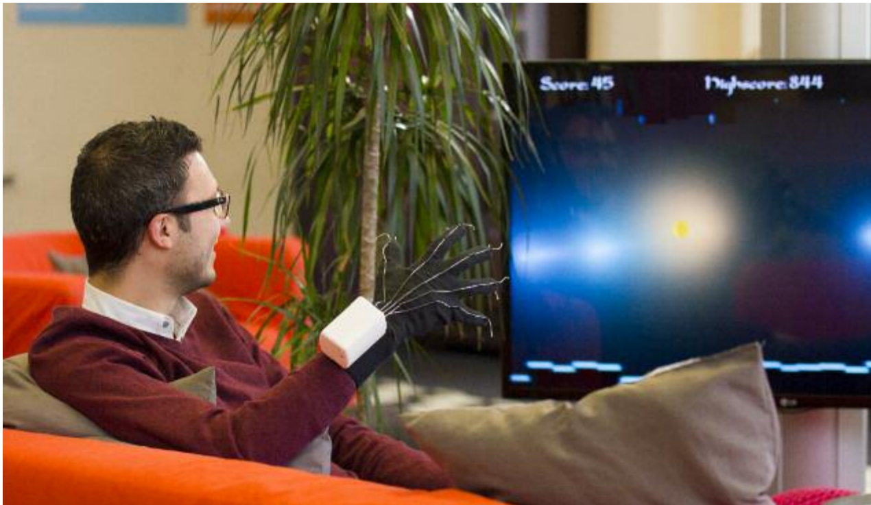
Der medizintechnische Handschuh von Cyteract unterstützt bei der Therapie von Handverletzungen. (Foto: Cyteract GmbH)
